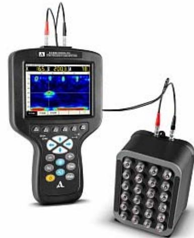
**Abb. 4.** Scherwellen-Ultraschallarray mit federnd gelagerten Punktkontaktprüfköpfen.
